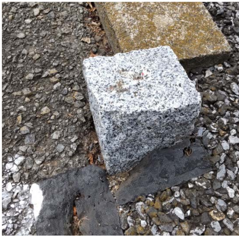
御影石の境界標 頭部の印が ○凹になっているのが特徴
